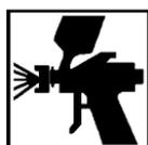
Appliquer avec un pistolet de pulvérisation équipé de buse  $\varnothing 1,9$ - $\varnothing 2,5$  mm avec pression de l'air à partir de 1,7 jusqu'à 2,2 bar.
